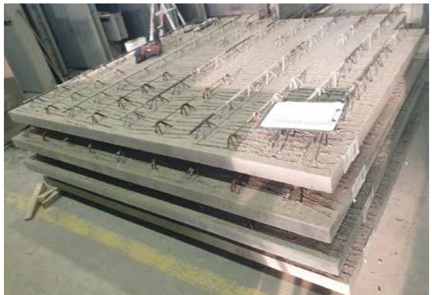
Fot. 1. Prefabrykowane stropy typu filigran
