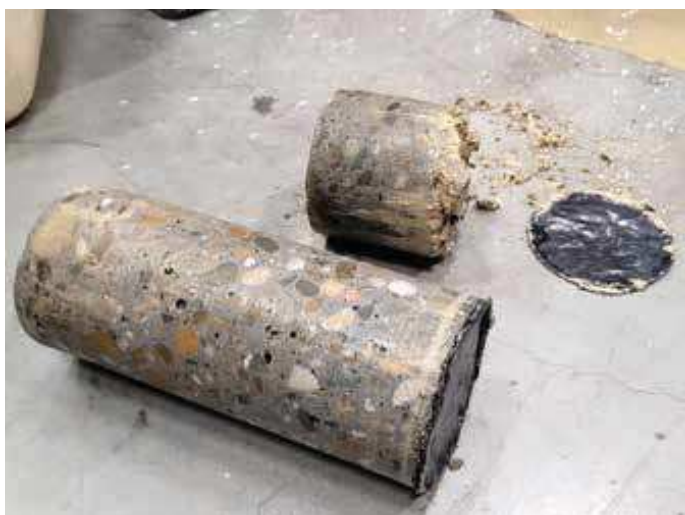
Fot. 12. Fragment folii i próbki rdzeniowe pobrane z wybranego punktu badawczego
