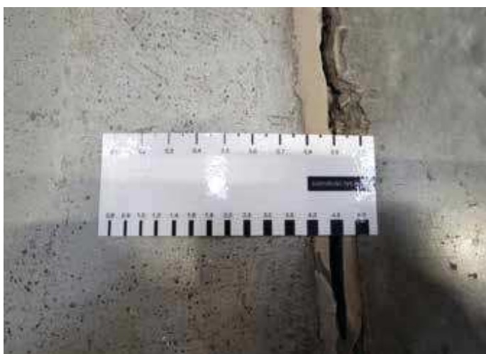
Fot. 10. Szerokość rozwarcia dylatacji roboczej
