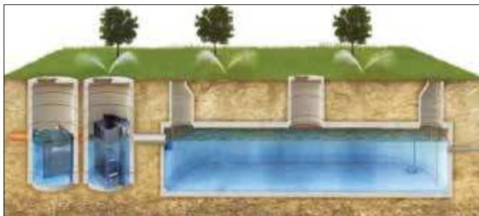
Rys. 1. Przykład zbiornika retencyjnego szczelnego [4]
