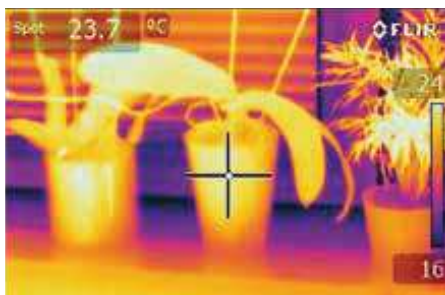
Fot. 12. Widoczne kwiatki na parapecie, w temperaturze pokoju. Termogram obrazuje napływ zimna do pomieszczenia (różnica temperatury 8K). Zły montaż stolarki okiennej lub brak regulacji
