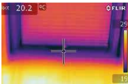
Fot. 14. Widok fragmentu okna połaciowego. Termogram obrazujący rzeczywisty napływ zimna do pomieszczenia na styku szyby z ramą oraz rami i ościeża (różnica temperatury 10K). Zły montaż stolarki drzwiowej i brak regulacji
