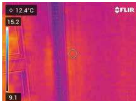
Fot. 17. Widok fragmentu budynku renowanego do standardu EnerPHit. Glif wewnętrzny wykonany klejem na siatce. „Ciepły” montaż okna (poza murem). Termogram obrazujący właściwą jakość termiczną styku połączenia ramy okna z ościeżnicą
