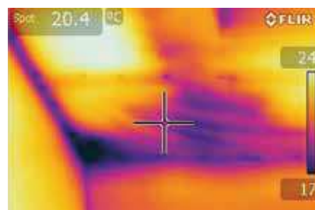
Fot. 7. Termogram. Poddasze ocieplone: przy murłacie, na krokwi i łacie oraz przy ścianie szczytowej widoczne „leżące języki zimna” na paroizolacji – nieszczelności, brak wełny w narożu
