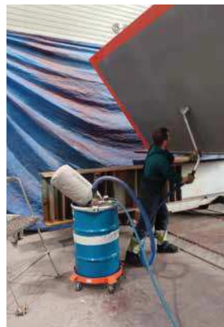
Fot. 6. Proces zdejmowania z powłoki etylokrzemianowej wysokocynkowej suchego natrysku
