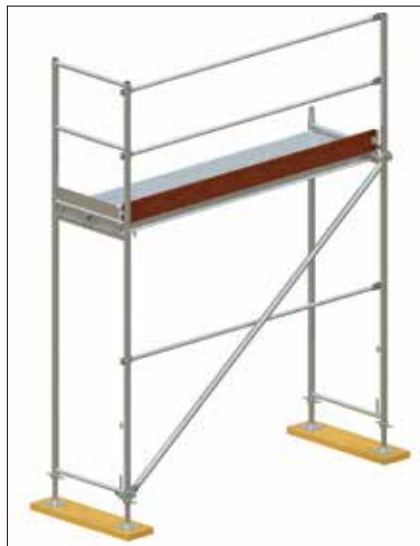
Rys. 1. Schemat rusztowania ramowego (bez pomostu komunikacyjnego)
