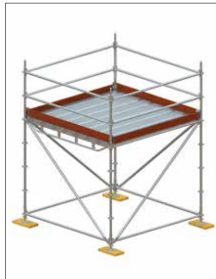
Rys. 2. Schemat rusztowania modułowego (bez pomostu komunikacyjnego)
