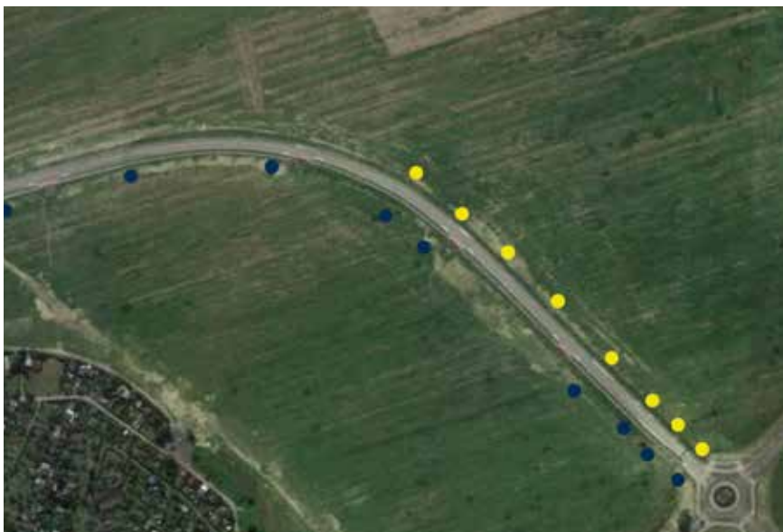
Rys. 1. Usytuowanie wszystkich punktów pomiaru wysokości zwierciadła wody gruntowej na badanym odcinku: żółte kropki – piezometry umieszczone w odległości do 1,50 m od krawędzi jezdni, strona prawa; granatowe kropki – piezometry umieszczone za ciągiem pieszko-rowerowym w odległości do 5,00 m od krawędzi jezdni, strona lewa
