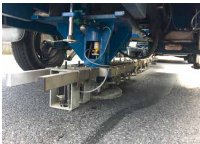
Fot. 6. Płyta obciążeniowa wraz z belką i zamocowanymi geofonami
