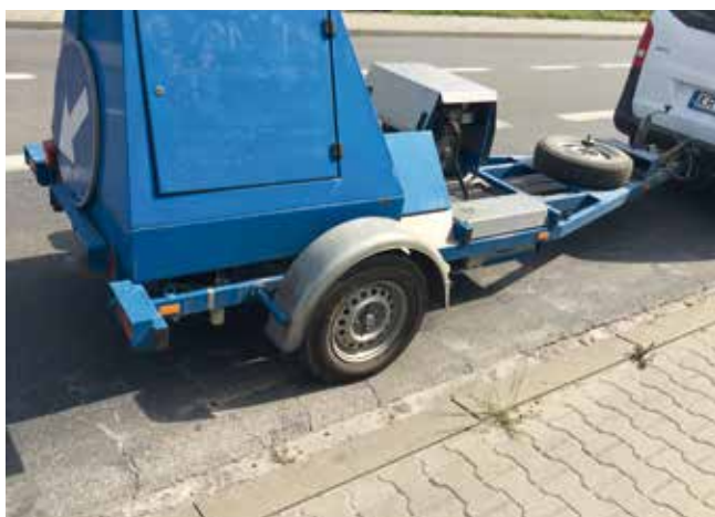
Fot. 5. Ugięciomierz dynamiczny FWD w formie przyczepy holowanej przez pojazd
