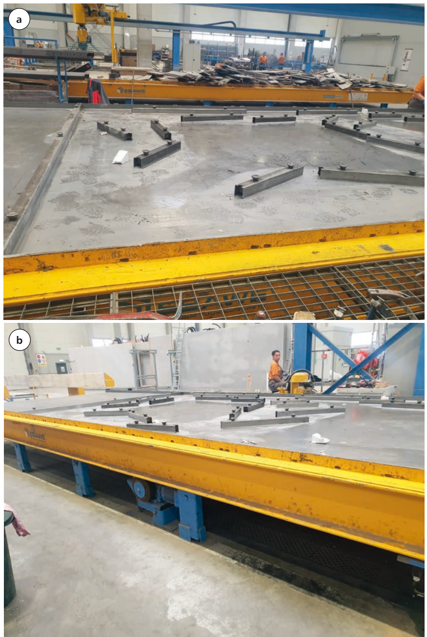
Fot. 3. a) Paleta z magnesami szalunkowymi, b) system napędu palet
