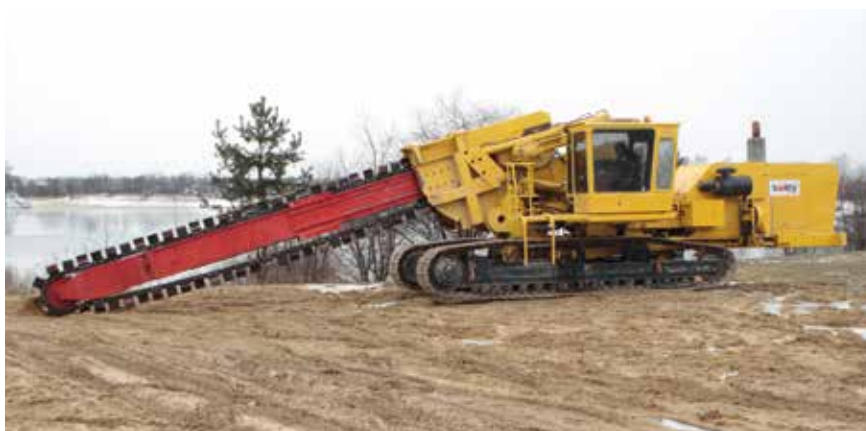
Fot. 4. Technologia CDMM do realizacji przesłon przeciwnieprzepływowych
